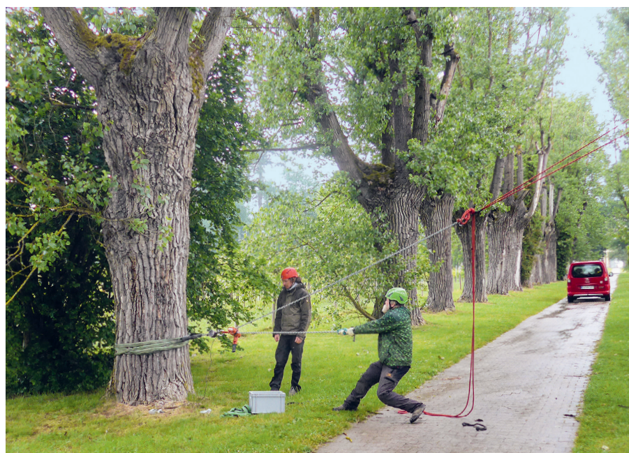
Abb 6: Vorbereitungen des Zugversuchs an einer Pappel der Jägerallee.
