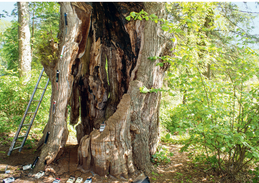
Abb. 7: Naturdenkmal Eiche Böttesheim mit Messung der Stand- und Bruchsicherheit mittels Elasto/Inclinomethode. Darüber eine intakte, 24 m hohe Baumkrone. Resttragfähigkeit gegenüber einem Vollstamm 3 Prozent. Grund-sicherheit (wenn der Stamm vollholzig wäre) 4400 Prozent. Gemessene Bruchsicherheit des Stammes 100 Prozent, Standsicherheit 115 Prozent. Wie will man das nach preislichen Gesichtspunkten vergeben?
